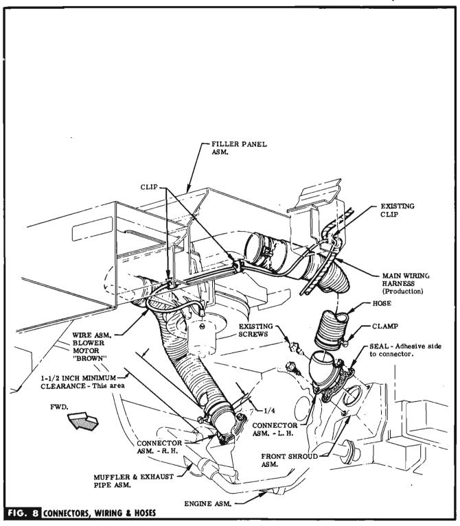
STEP 42 REMOVE COVERS FROM FRONT SHROUD ASM. & DISCARD. RETAIN SCREWS.
